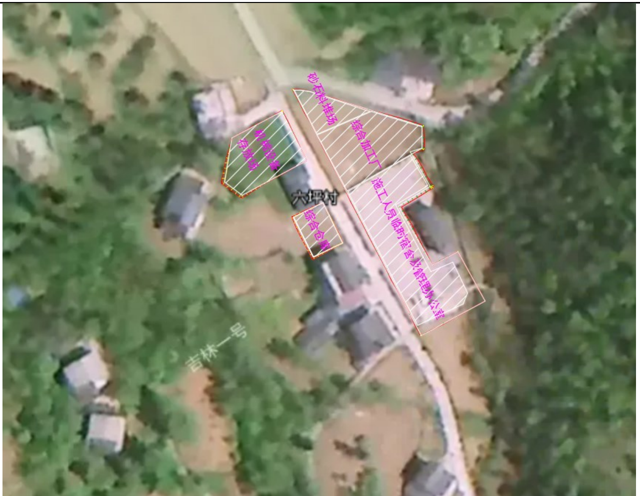
图 2.2-1 临时施工生产生活区布置
