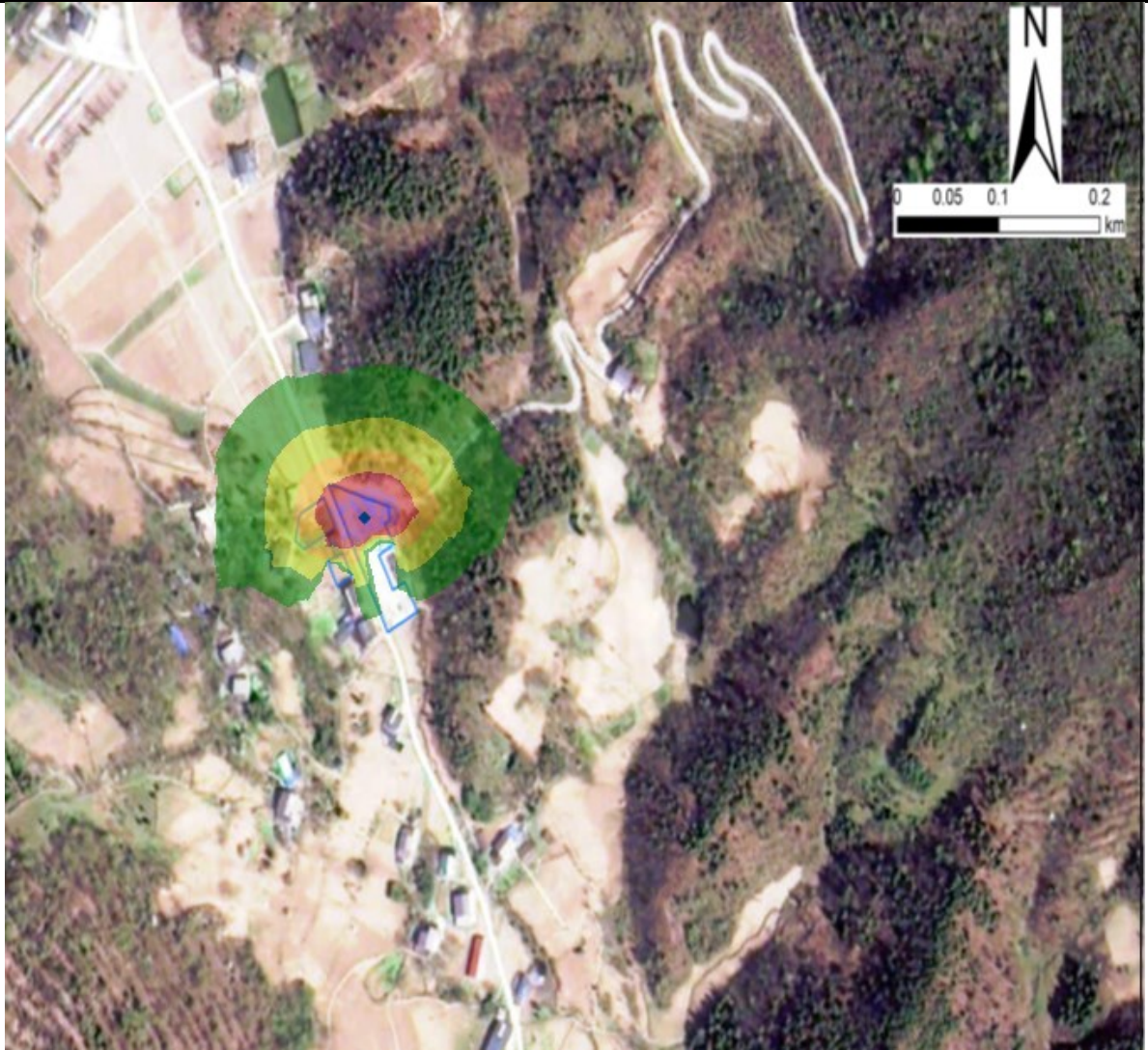
图6.2 单台切割机运行时噪声等值线图
